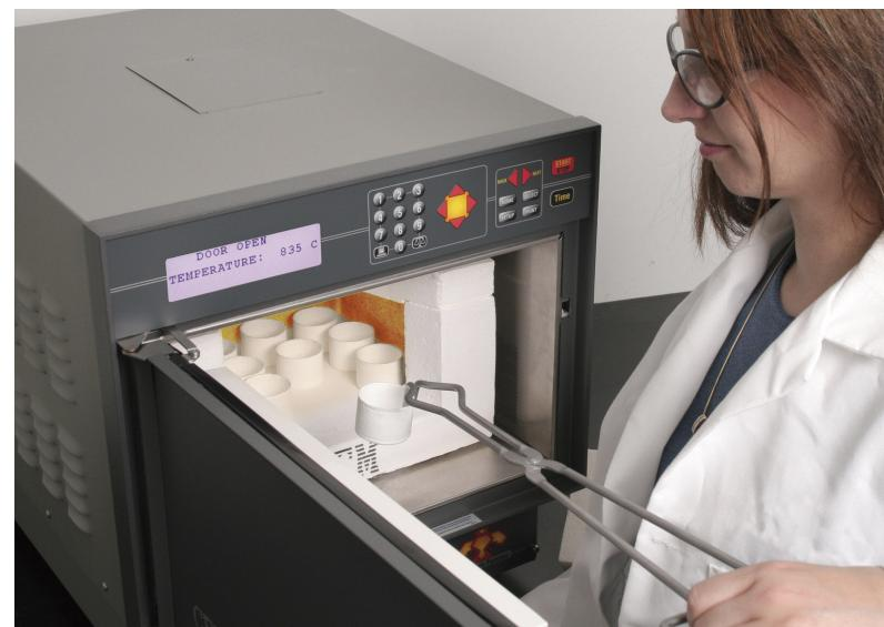
Der Phönix Muffelofen kann für Schmelzaufschlüsse und sämtliche Veraschungen mit Temperaturen bis zu 1200 °C benutzt werden
