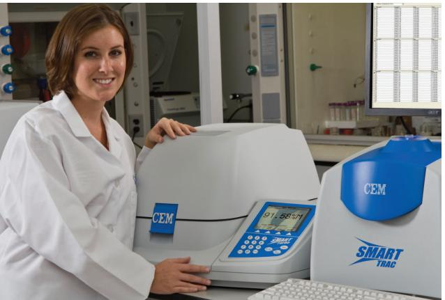
Das SMART Trac II und das HybridTrac-Analysensystem stellt die ideale Kombination aus dem Mikrowellentrockner SMART Turbo und der NMR-Hochleistungstechnologie zur schnellen und präzisen Feuchte- und Fettbestimmung dar. Im Zusammenspiel von vielseitiger und zuverlässiger Mikrowellentrocknung mit anschließender Fettbestimmung im NMR-Modul werden präzise Resultate ohne organische Lösungsmittel und ohne Kalibration in Minuten schnelle erzielt.
