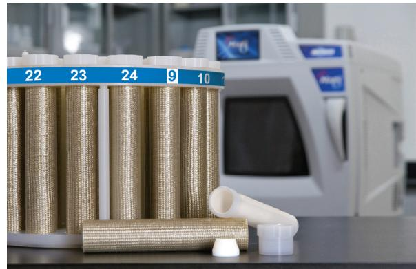
Bis zu 24 Proben können mit diesen Glaseinsätzen im Xpress Plus System schnell und effizient abgearbeitet werden.
