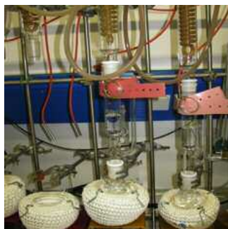
Extraktionszeiten bis zu 24 Stunden sind bei der Soxhlettextraktion keine Seltenheit
