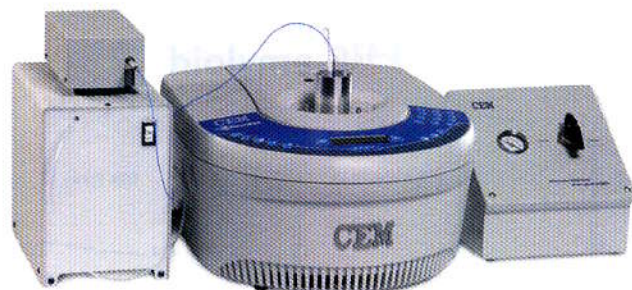
Abb. 6: Das CEM Discover ausgerüstet zur beschleunigten Protein-Hydrolyse
