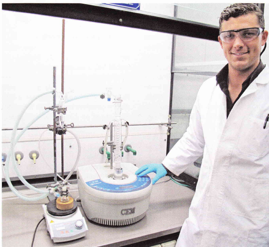
1 Laborapparatur zur Synthese von Cyclocarbonaten im offenen Mikrowellensystem: Reaktionsgefäß mit 1,4-Butandiol diglycidylether (links), offenes Mikrowellensystem bestückt mit Rückflusskühler und Schlauchsystem (rechts).
