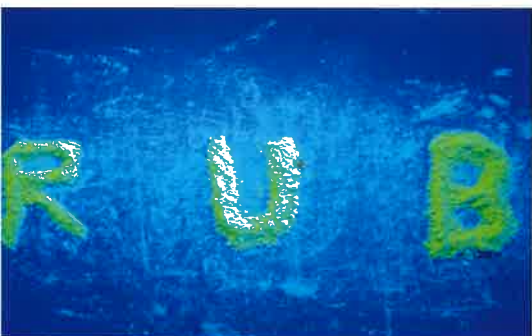
Bild 7. Hier leuchtet Natriumgadoliniumfluorid dotiert mit Erbium und Ytterbium grün.
